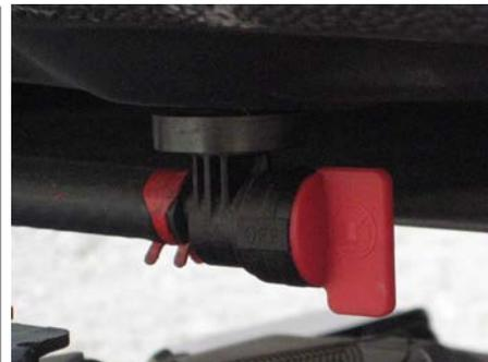
5. Mueva la palanca del ahogador (L) a la posición de "Choke".
